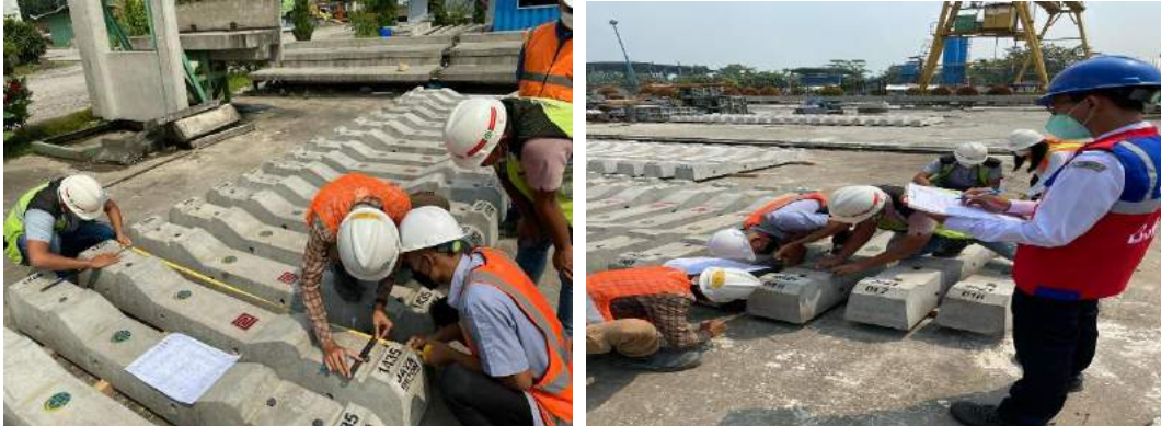
Gambar 4- 28 Pengujian Bantalan Beton
